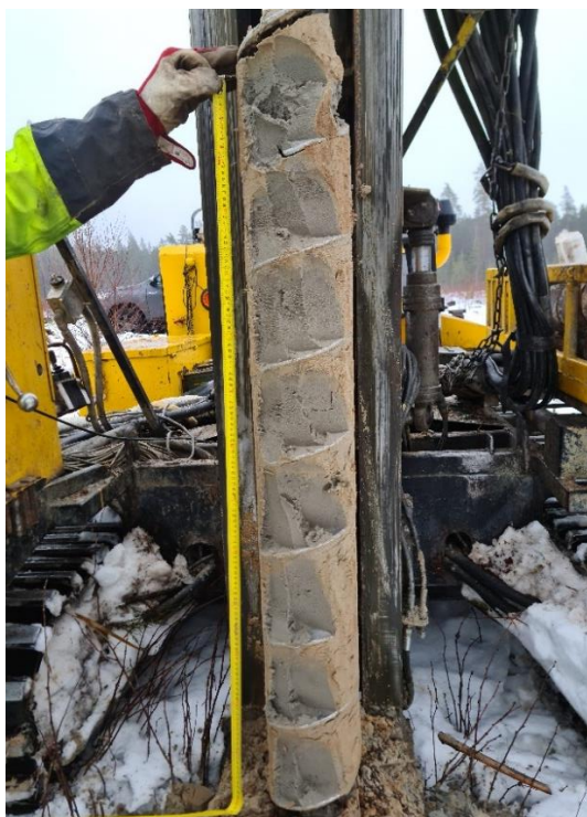
Foto 5.1. Ülipeeneteraline hall liiv puuraugus J-6 (foto S. Siir 18.12.2023, 58°42'13"pl 24°26'56"ip)
