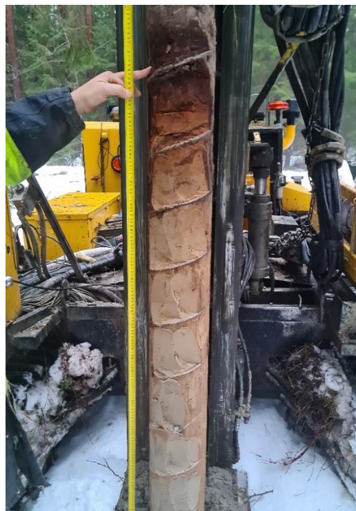
Foto 5.2. Kasvukiht ja ülipeeneteraline beež ja hall liiv puuraugus J-12 (foto S. Siir 18.12.2023, 58°42'20"pl 24°27'15"ip)
